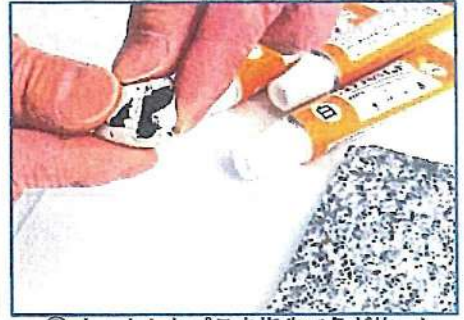
③ カットしたパテを指先で色が均一に なるまで練ります。 また、パテ(白)にシンナーで希釈 したエナメルペイントを加えて 混ぜ合わせる事で着色ができます。 ※目安 パテ幅約2cm、約5滴 ※パテ同士を混ぜ合わせ調色可能
