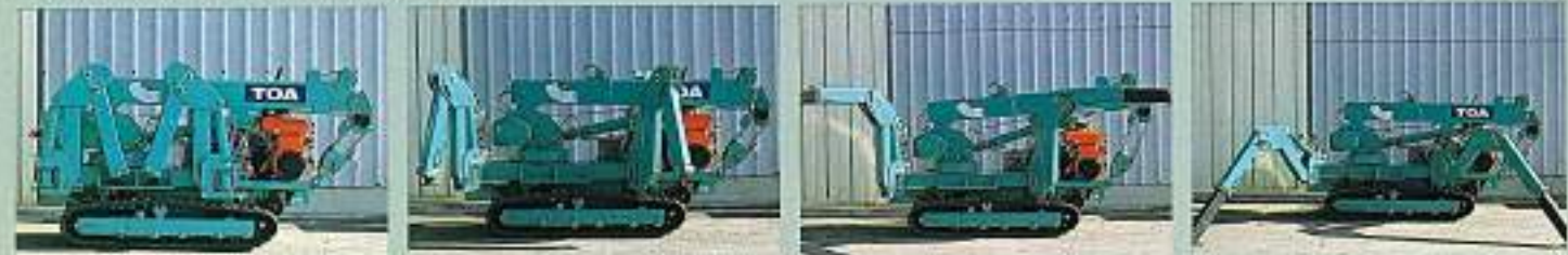
①搬入 ②アウトリガーを広げる ③アウトリガーを伸ばす ④油圧で踏んばる
