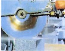
なめらかな使用感で、高精度切断に適したカットマシン用ブレードです。切断作業に適した「標準刃」と、やわらかい加工に適した「厚刃」の2種類を用意しております。
