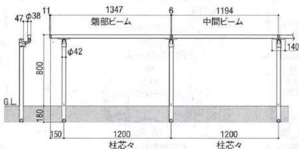
フロントビーム1段埋込柱仕様(φ38手すり)
