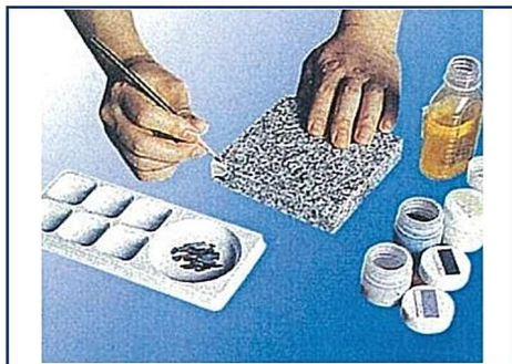
⑤ 硬化後、余分な部分を研磨します パウダーを密着液で溶かし、着色または柄を描きます
