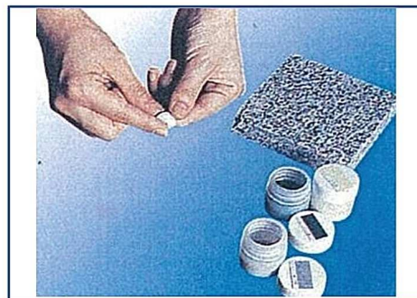
③ カットしたスティックパテを指先やパレットの上で十分に練ります パテにパウダーを練り込み、色合わせをします
